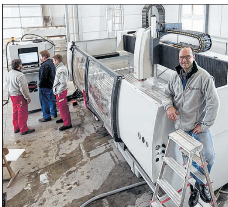
Frank Ostertag (rechts) und Mitarbeiter mit einer computergesteuerten Maschine, mit der Steine bearbeitet werden können. Foto: Oliver Schulz
